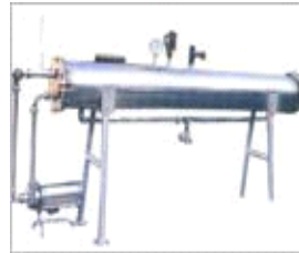
图 11 管式杀菌机示意图
